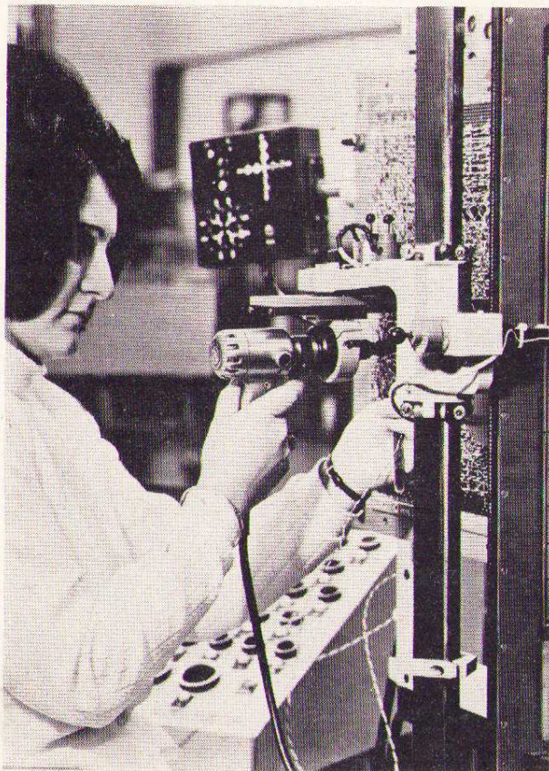
Bij het bedraden van de plateaus wordt gebruik gemaakt van ponsbandbesturing, waardoor het maken van foutieve verbindingen is uitgesloten.
